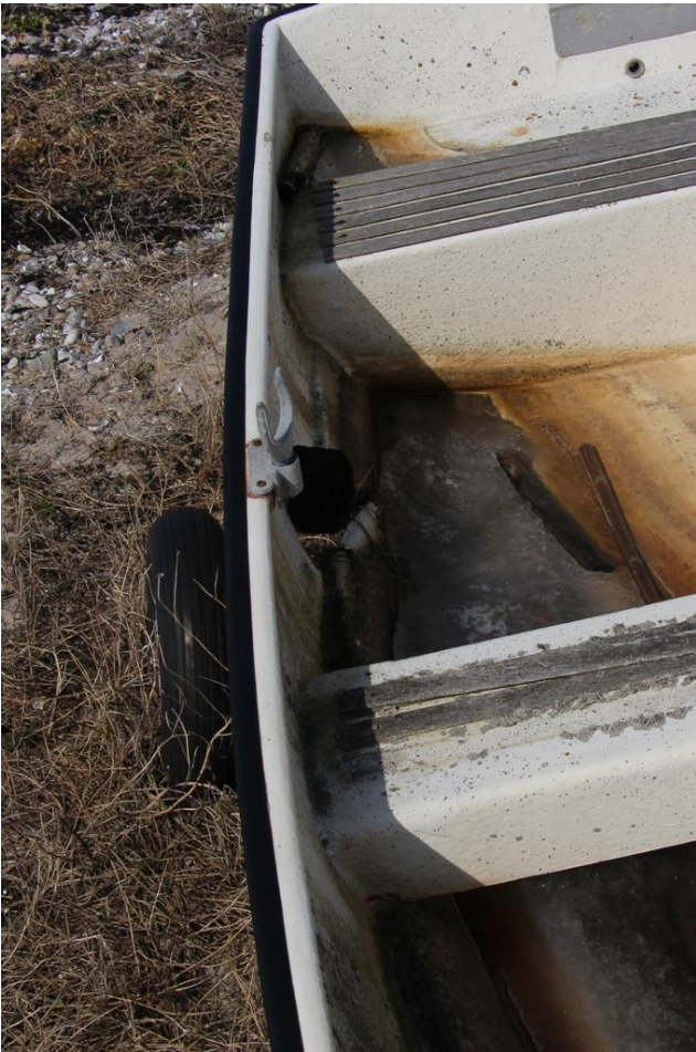
Støtten er gået gennem bunden, og endnu et tilsandet og rustent spil.
